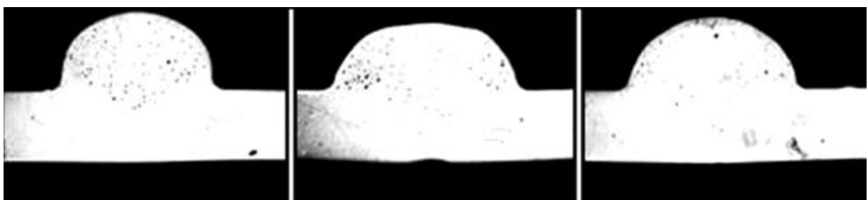
Рис. 6. Макрошлифы сварного соединения, выполненного процессом СМТ
