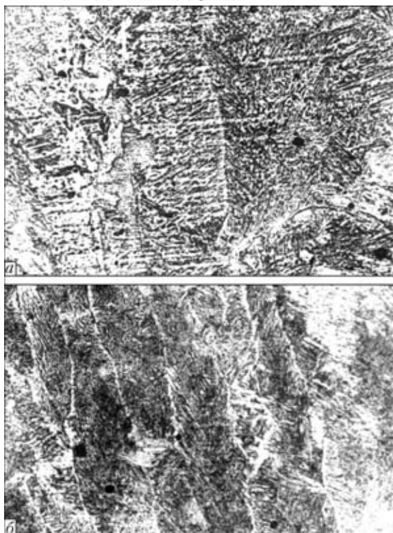
Рис. 3. Микроструктуры металла сварных швов: a — штатная технология; b — с ЭМВ при B = 10 мТл, \times 200
