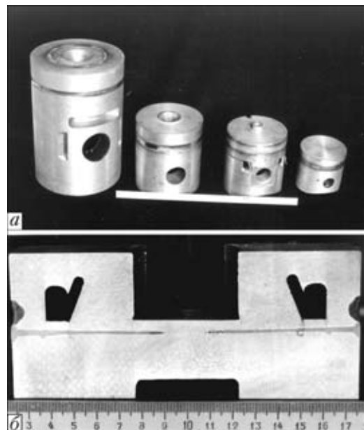
Рис. 5. Типоразмерный ряд сварных поршней (а) и макрошлиф головки поршня с полостью масляного охлаждения и упрочняющей наплавкой зоны верхней компрессионной канавки, выполненных ЭЛС (б), [19]
