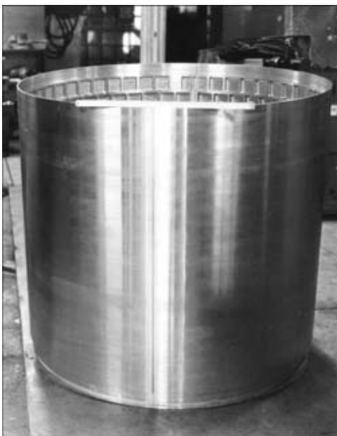
Рис. 3. Внешний вид фрагмента крупногабаритной обечайки из сплава АМгб диаметром 1145 мм и толщиной свариваемых кромок 90 мм
