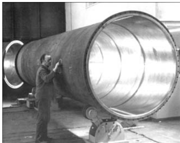
Рис. 3. Труба диаметром 1500 мм, плакированная изнутри слоем тантала СВ
