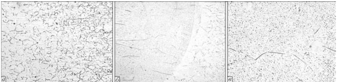
Рис. 7. Микроструктура сварного соединения сплава 32НКА, выполненного электронно-лучевой сваркой, на участке перехода от зоны рекристаллизации к металлу шва: a — зона рекристаллизации вблизи шва, \times 150 ; b — зона сплавления, \times 150 ; в — металл шва, \times 250
