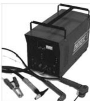
Научно-производственное предприятие «Плазмотрон» НТК «ИЭС им. Е. О. Патона» является традиционным разработчиком и производителем установок для воздушно-плазменной резки (ВПР). Накопленный многолетний опыт позволил создать оригинальные, не имеющие аналогов в мировой практике, установки «Дуплекс-1М», «Дуплекс-1А» и «Дуплекс-2М», сочетающие ряд важных преимуществ. К ним относятся:
