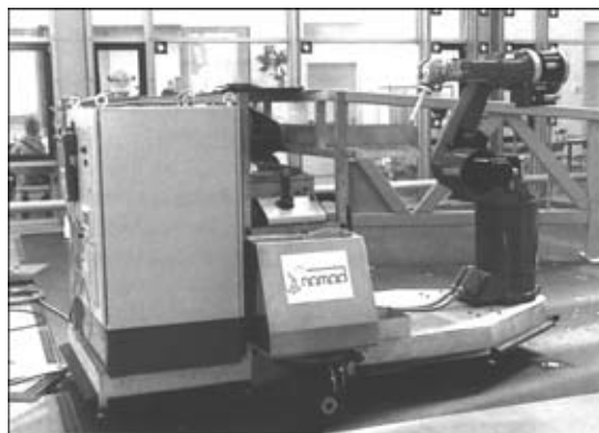
Рис. 1. Тележка-робокар с размещенным на ней роботом, сварочным оборудованием и системами управления
