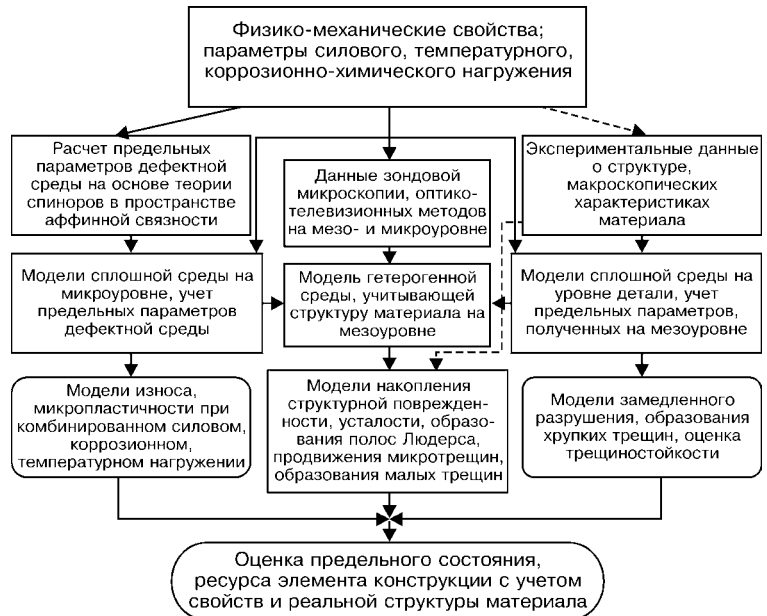
Рис. 1. Общая схема комплексных исследований процессов деформирования и разрушения гетерогенных сред на основе иерархической модели
