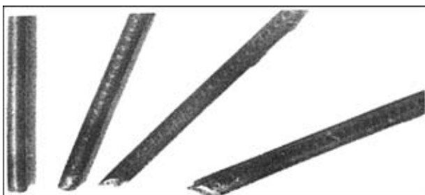
Рис. 3. Характер оплавления торца электрода
