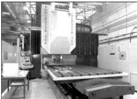
Рис. 23. Установка «Power Stir-360» фирмы «Crawford Swift» (Великобритания) мощностью 60 кВт
