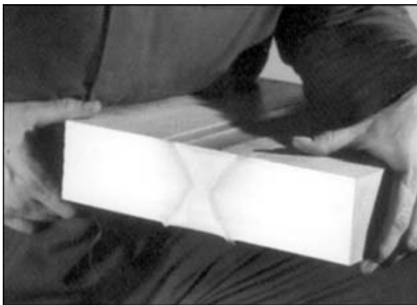
Рис. 12. Макроструктура двухстороннего соединения плит сплава 6082 T6 толщиной 75 мм
