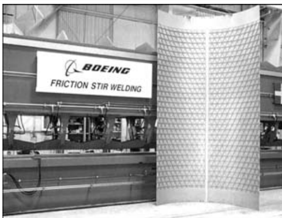
Рис. 22. Фрагмент топливного бака ракеты «Delta» с продольным СТП швом
