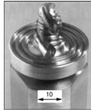
Рис. 13. Прототип инструмента с торговым знаком MX Triflute™
