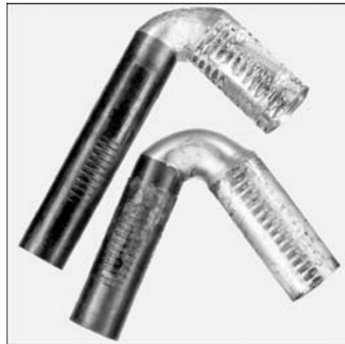
Рис. 6. Соединения ( P_n = 40...60 МПа, P_{np} = 200 МПа, t_n = 0,4 с, t_T = 0,7 с) после механических испытаний на ударный загиб
