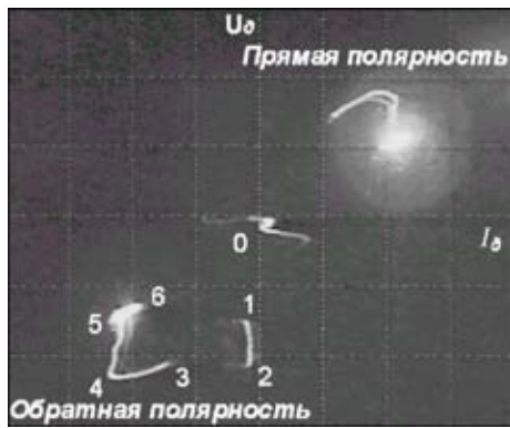
Рис. 5. Динамическая вольт-амперная характеристика дуги переменного тока прямоугольной формы при I_d = 100 А, \tau_{пр} = 16,25 и \tau_{обр} = 3,75 мс (масштаб по напряжению 10 В/дел.)
