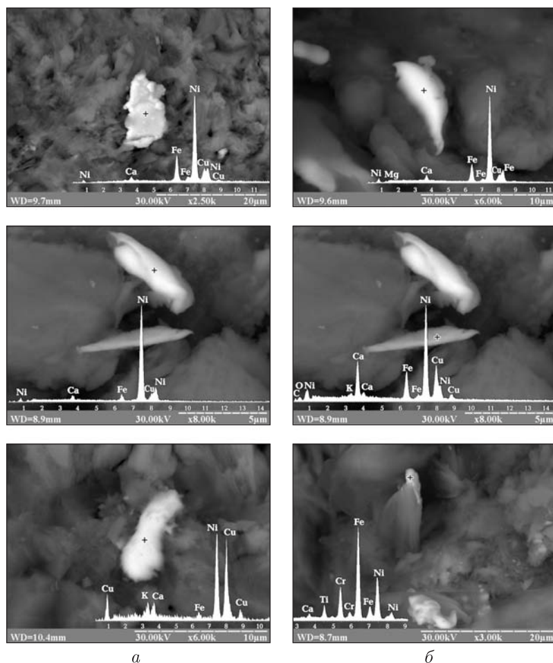
Рис. 4. Частицы самородного никеля и его природных сплавов с медью и железом (с различным количественным соотношением Ni, Cu и Fe)
