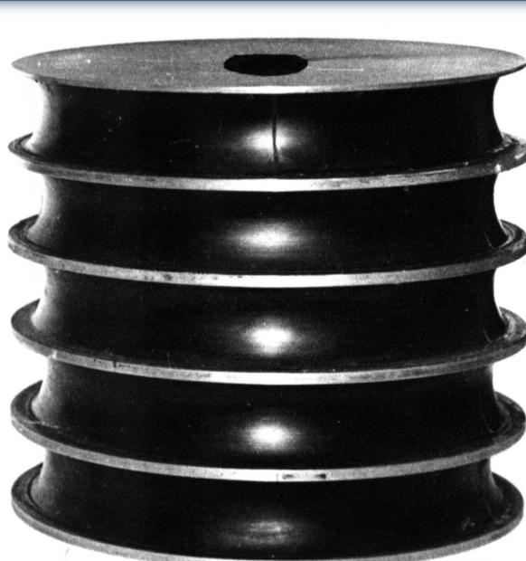
Рис. 5 – Виброизолирующая опора дробилки КИД-2200
