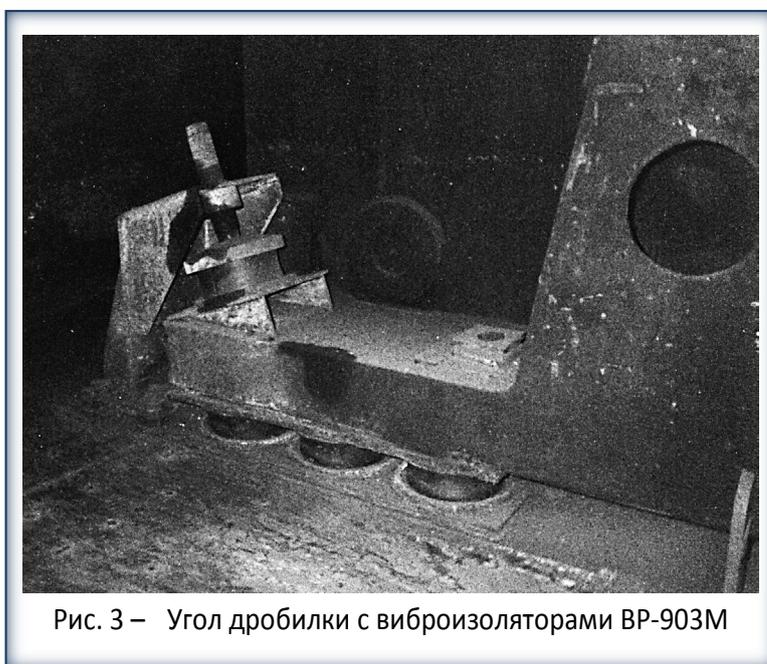
Рис. 3 – Угол дробилки с виброизоляторами ВР-903М
