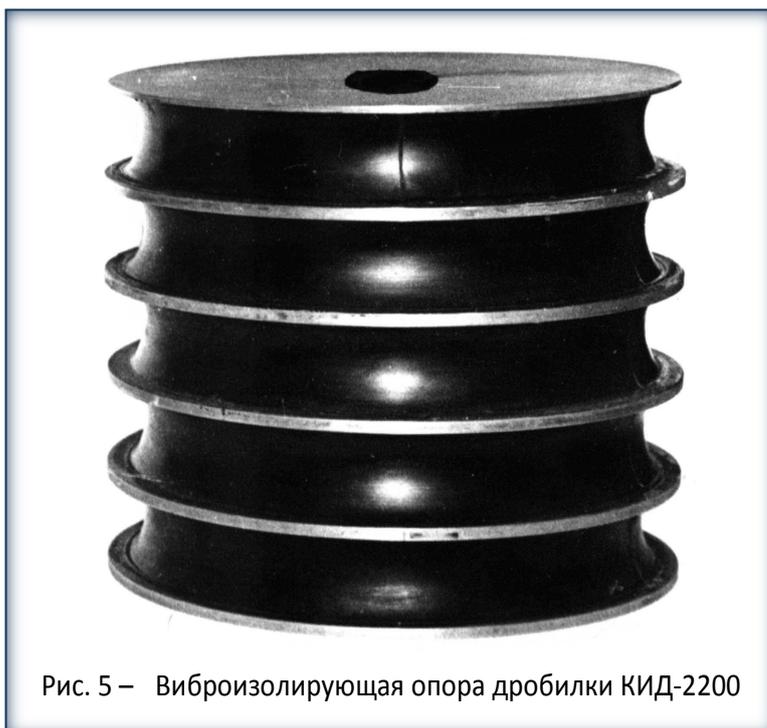
Рис. 5 – Виброизолирующая опора дробилки КИД-2200
