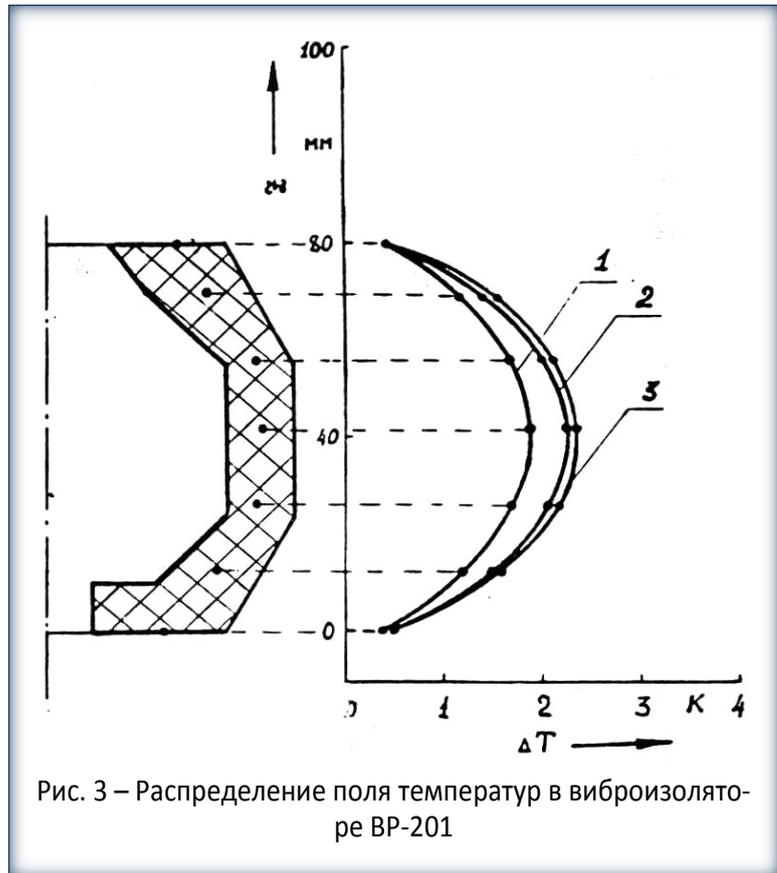
Рис. 3 – Распределение поля температур в виброизоляторе BP-201
