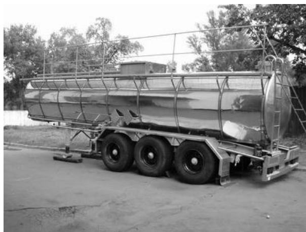
Рис. 3 - Магистральный доставщик компонентов ЭВВ модели ДРОМ
