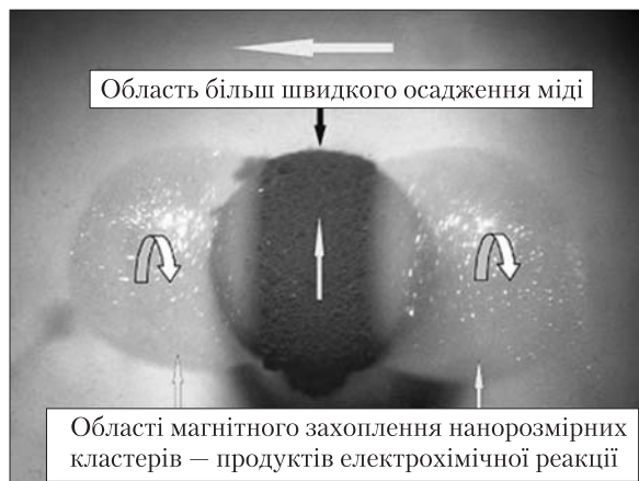
Рис. 2. Приклад впливу магнітостатичних полів розсіювання намагніченої в зовнішньому магнітному полі сталевій кулі на перебіг електрохімічної реакції цементацийного осадження міді з водного розчину \text{CuSO}_4 на її поверхні
