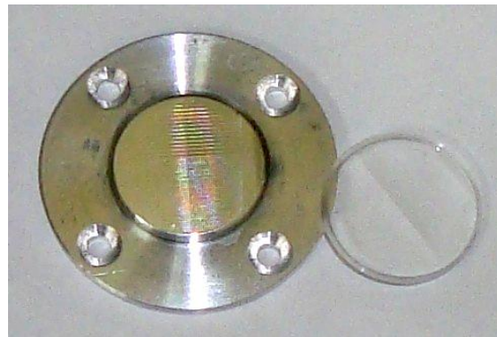
Рис. 7. Послаблювач білого світла на принципі дифракційного розширення зображень
