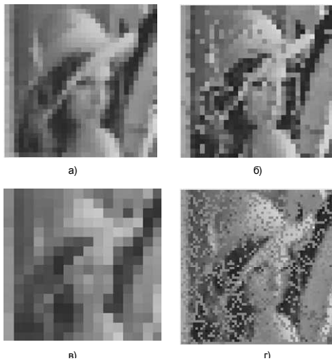
Рис. 5. Примеры восстановленных изображений: а) МПИ с разбиением 32x32 ВФПЭ и структурой тестового изображения 32x32; б) МПИ с разбиением 32x32 ВФПЭ и структурой тестового изображения 256x256; в) МПИ с разбиением 16x16 ВФПЭ и структурой тестового изображения 16x16; г) МПИ с разбиением 64x64 ВФПЭ и структурой тестового изображения 64x64
