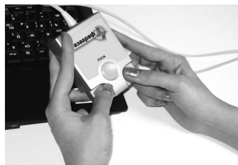
Рис. 3. Микропроцессорный сенсор с пальцевыми электродами для регистрации ЭКГ
