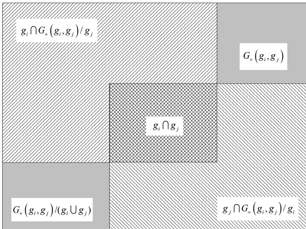
Рисунок 2 – Базовые множества для построения всех возможных топологических отношений на гранулах  $g_i$  и  $g_j$
