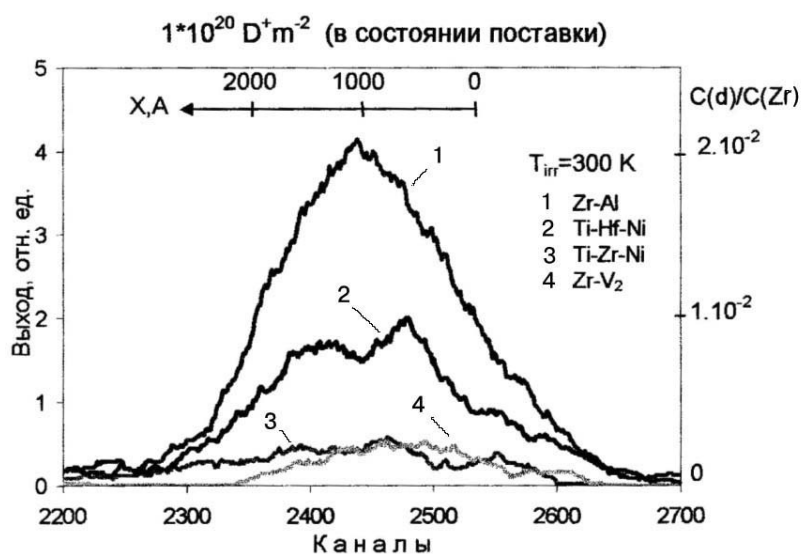
Рис. 2. Профили распределения дейтерия в Zr+16%Al, ZrV 2 , 41,5Ti+41,5Zr+17Ni, 41,5Ti+41,5Hf+17Ni после имплантации при комнатной температуре
