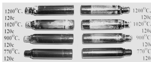
Рис. 3. Внешний вид макетов твэлов с оболочкой из сплавов Э110 и Zr1Nb без избыточного внутреннего давления после испытаний в паре при давлении 0,1 МПа и при указанных на рисунке температурах
