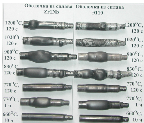
Рис. 4. Внешний вид макетов твэлов с оболочкой из сплавов Zr1Nb и Э110 с исходным внутренним давлением 2,2 МПа после испытаний в паре при давлении 0,1 МПа при указанных на рисунке температурах и временах выдержки (на некоторых образцах видны следы компоновочной проволоки)
