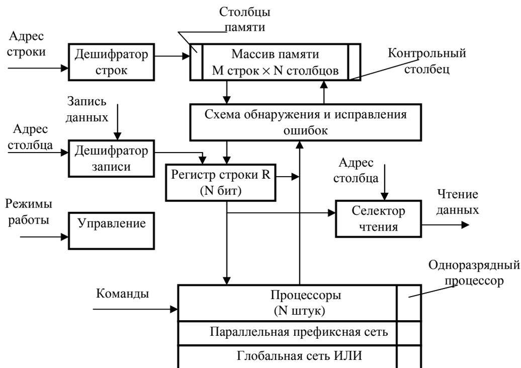
Рис. 5. Блок-схема РИМ-чипа процессорной памяти
