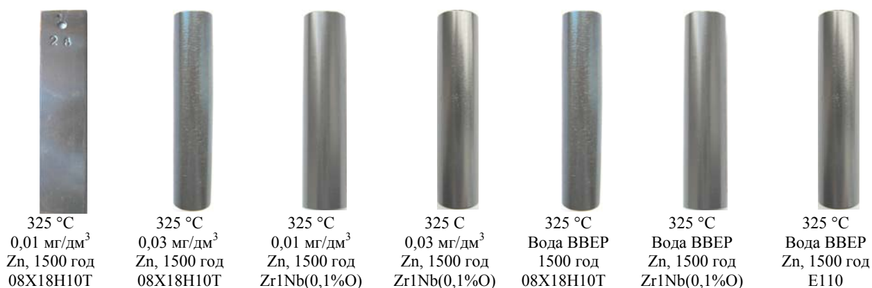
Рис. 11. Зовнішній вигляд зразків нержавіючих сталей і цирконієвих сплавів після окислення при температурі 325 °С протягом 1500 год у середовищі з добавкою Zn
