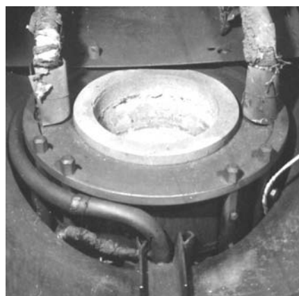
Рис. 2. Схема (а) и общий вид (б) тигля со сливом расплава через отверстие в днище: 1 – водоохлаждаемая емкость; 2 – катушки; 3 – магнитопровод; 4 – пробка сливного отверстия; 5 – сливной коллектор; б – канал охлаждения
