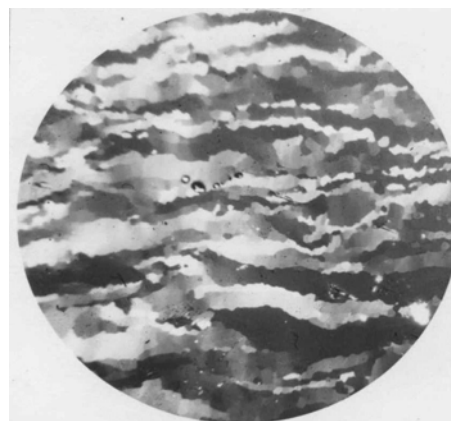
Рис. 1. Структура бериллия после прокатки при температуре 850 °С. Суммарная степень деформации 80%; x 115
