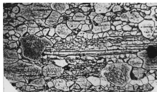
Рис. 4. Структура бериллия после прокатки при температуре 600 °С; x 560
