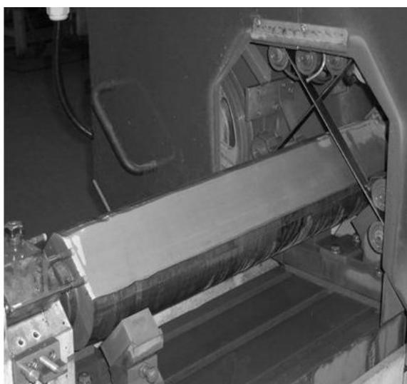
Рис. 4. Квадратирование монокристаллического слитка кремния
