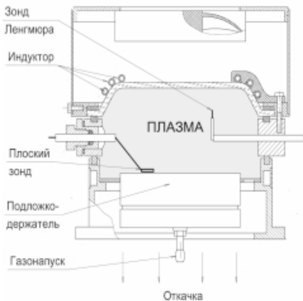
Рис. 1. Принципиальная схема и фотография плазмохимического реактора.
