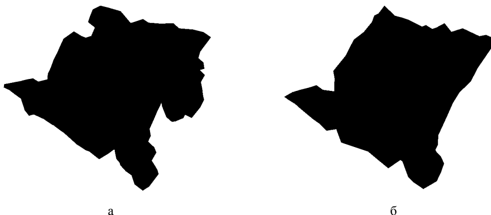
Рис. 5. Рельеф атомной поверхности осаждаемой пленки ниобия: а – после осаждения 25 монослоев ниобия; б – после осаждения 29 монослоев ниобия. В результате структурной перестройки одна из “микротрещин” исчезает. В результате этого процесса образуется краевая дислокация в объеме пленки
