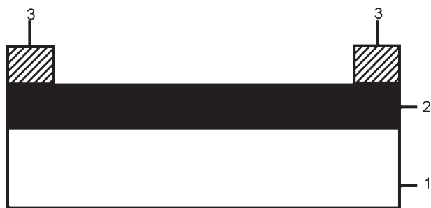
Рис. 1. Схема сцинтилляционного фотодетектора излучения на основе CdTe-ZnSe: 1 – ZnSe, 2 – CdTe:Ag, 3 – контакты.
