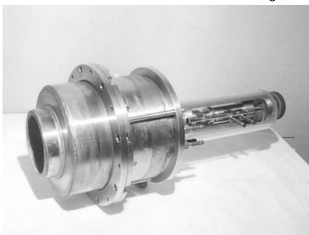
Фіг.2. Плазмове джерело з пересувним вузлом ущільнення.
