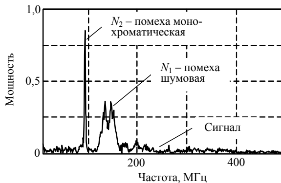
Рис. 3. Нормированная спектральная плотность мощности отраженного сигнала, шумовой N_1 и монохроматической N_2 помехи
