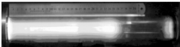
Рис. 4. Фотография разряда при давлении азота p = 1 Торр и разрядном токе 46 мА. Анод располагается слева, катод – справа.
