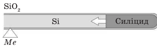
Рис. 1. Схема реакції між металом і кремнієм всередині кремнієвого нанодроту, покритого тонким шаром оксиду. Місце контакту нанодротів металу і кремнію, через яке відбувається проникнення металу у кремній, позначено білим трикутником. Стрілкою показано напрям розростання силіциду металу від кінця дроту всередину.
