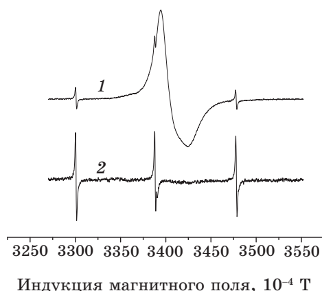
Рис. 1. Спектры ЭПР исходных образцов (гидроксидов), отожженных в течение 1 часа в атмосфере водорода без предварительного отжига на воздухе. Цифры 1 и 2 соответствуют температурам отжига 250°C и 650°C.
