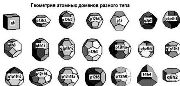
Рис. 1. Набор доменов, потенциально пригодных для восстановления трёхмерной архитектуры ячеистого пространства произвольной наносистемы в модели «Атомные соты».
