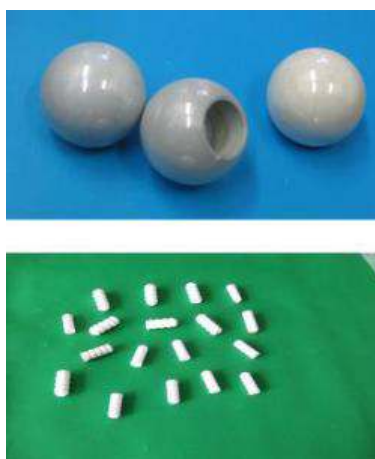
Рис. 8. Опытные образцы имплантатов, изготовленные из композита на основе ZrO_2 : а) керамические головки эндопротезов тазобедренного сустава; б) керамические дентальные имплантаты (искусственные корни зубов).
