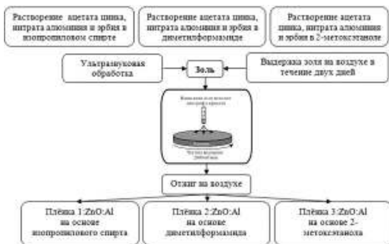
Рис. 1. Блок-схема синтеза золь-гель-методом слоёв на основе плёнок ZnO:Al.
