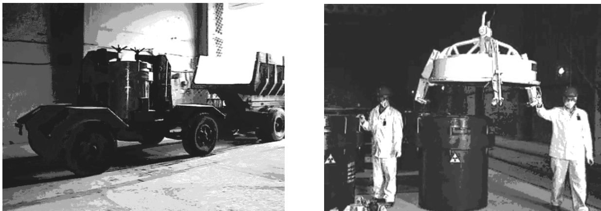
Рис. 5. Ввоз платформы с КТЗВ-0,2 в ВХТВАО и размещение упаковки в месте временного хранения.
