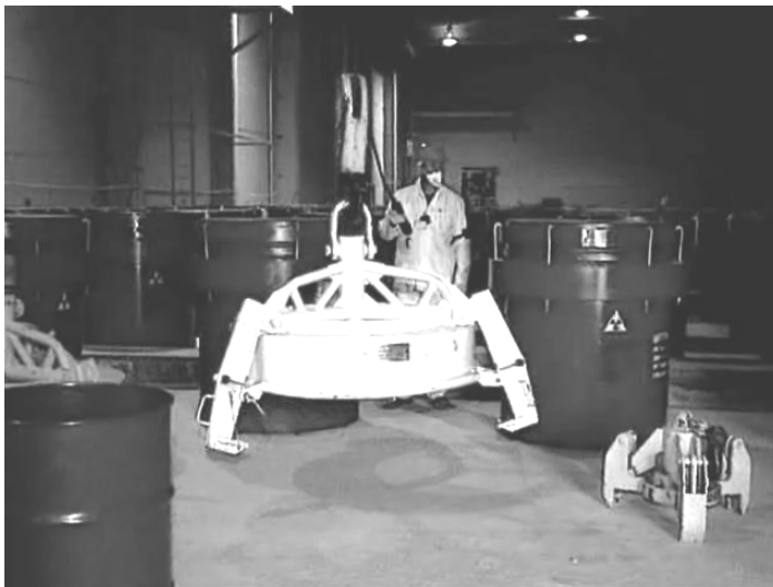
Рис. 6. Грузозахватное приспособление для перемещения спецконтейнеров.
