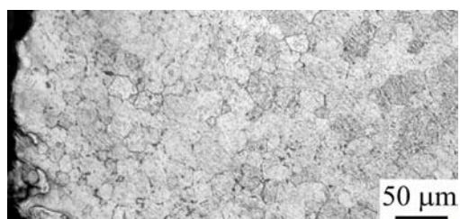
Рис. 5. Микроструктура деформированного поверхностного слоя шара после рекристаллизационного отжига
