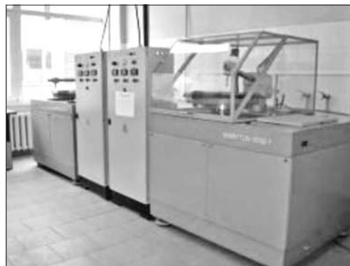
Установка химико-механического полирования пластин сапфира «Камертон-500Д-1», разработанная в НТК «ИМК» НАНУ и изготовленная в ЦКБ «Донец»
