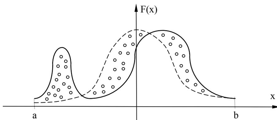
Рисунок 3 – График несоответствия функций: сложного вида распределения (полимодального) и сигмоидальной АФН (пунктиром)
