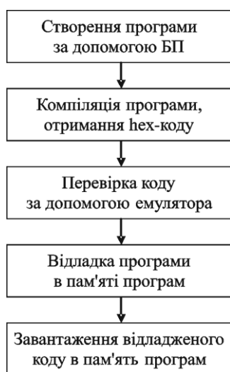
РИС. 5. Послідовність процедур програмування приладів
