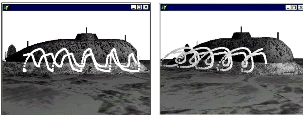
РИС. 3. Картина двух рассчитанных траекторий (в двух ракурсах) подводного робота-зонда, перемещающегося в зоне течения за подводным объектом в режиме адаптивного управления по оси объекта и участвующего в этом вихревом движении (суммарное движение робота принимает вид одной из показанных спиралевидных траекторий)
