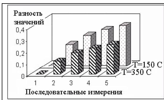
РИС. 3. Сравнения амплитуды сигналов последовательных измерений относительно уровня сигнала в реф. газе для двух температур нагрева слоя: T = 150 и 350\text{ }^{\circ}\text{C}
