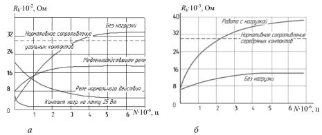
Зависимость переходного сопротивления фронтовых (угольных) (a) и контактов из серебра  $(\delta)$  от количества срабатываний.
