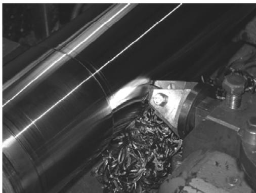
Рис. 2. Инструмент для “бреющего” резания в работе.
