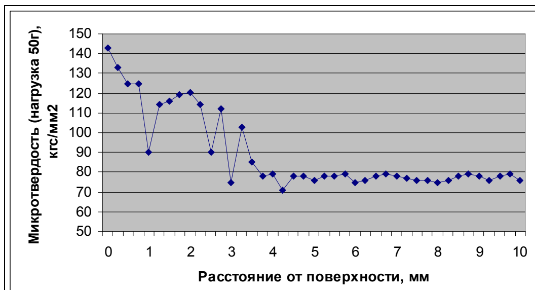
Рис. 3. Распределение микротвердости по глубине наплавленного никелевого слоя на медную основу
