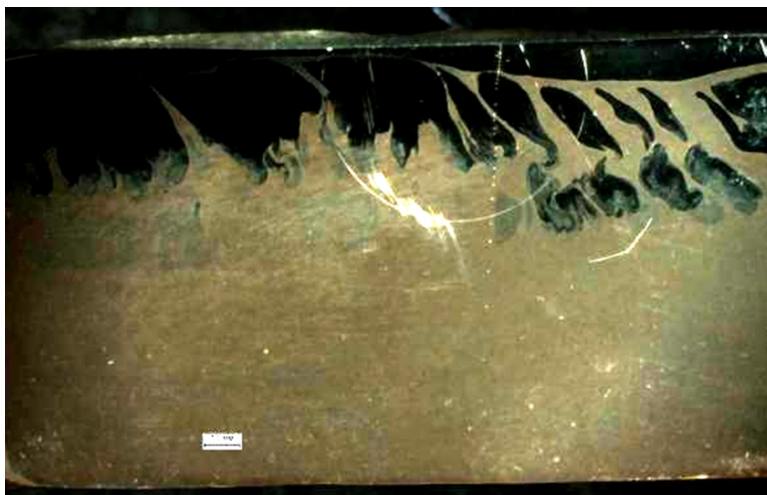
Рис. 1. Внешний вид образца меди с никелевым покрытием (оптический микроскоп – поперечное сечение образца)
