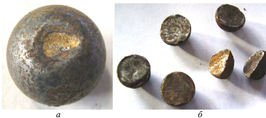
Рис. 5. Руйнування кульок замкового підшипника опори: а – сколювання фрагменту кульки; б – розколювання кульок пополам і на декілька частин
