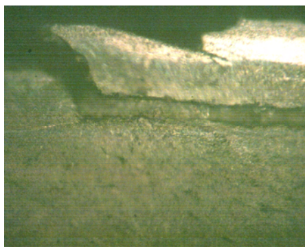
Рис. 4. Відшарування фрагментів цементованого шару на упорному торці шарошки зі сталі 14ХНЗМА-В ( \times 500 )
