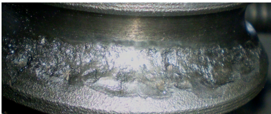
Рис. 3 Характер крихкого руйнування бігової доріжки замкового підшипника в навантаженій стороні цапфи лапи
