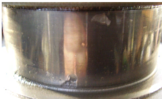
Рис. 2. Втомне контактне руйнування в навантаженій зоні цапфи лапи по краях бігової доріжки великого роликового підшипника
